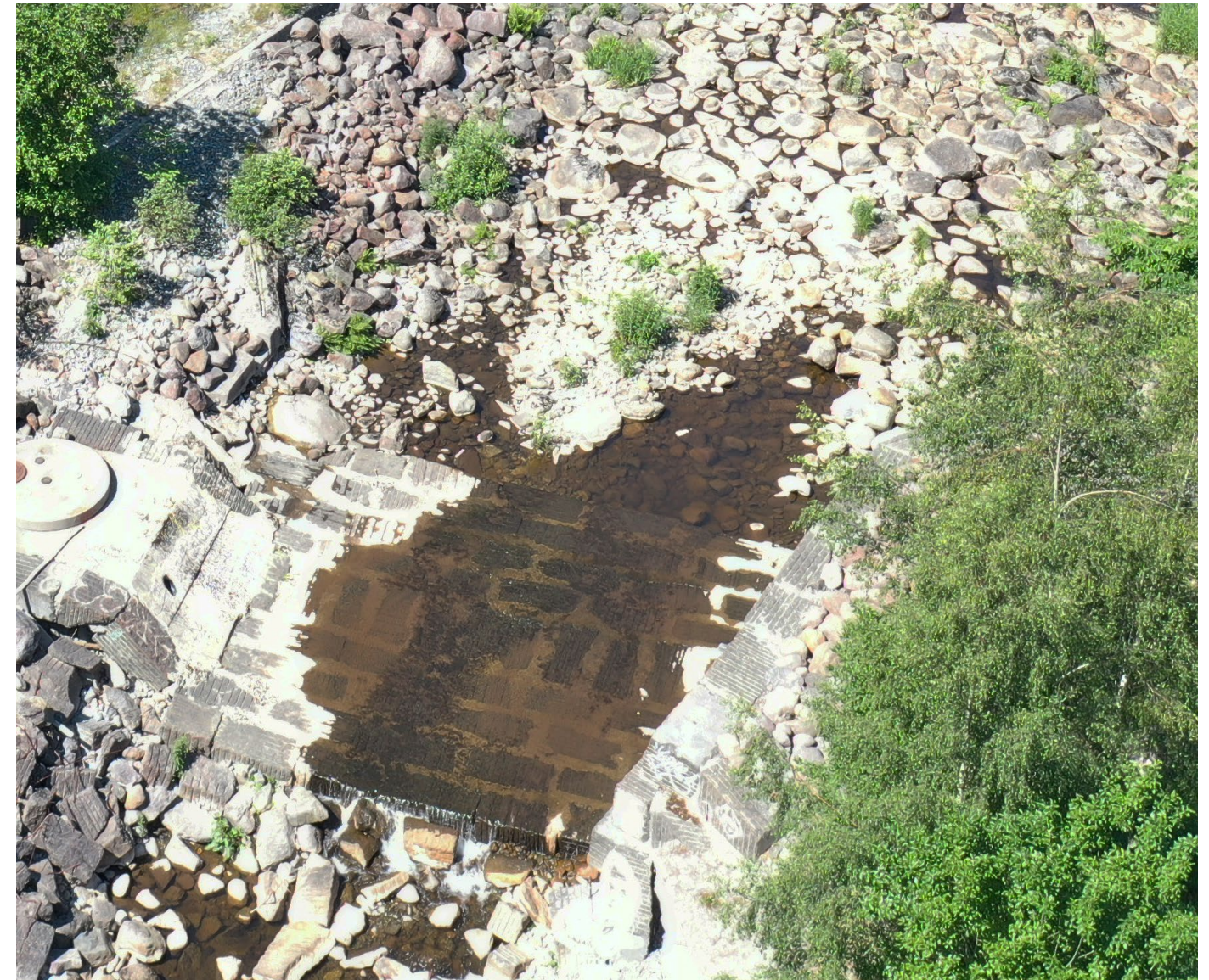
Figur 20 Vannføring over denne steinterskelen omtrent midtveis på elvestrekningen var den 21. juni 2023, etter en lang periode uten nedbør, betydelig lavere enn det som er foreslått som minstevannføring om vinteren med 100 l/s. Vannføring på ca. 80 l/s er vist i fig. 1 og fig. 17.
