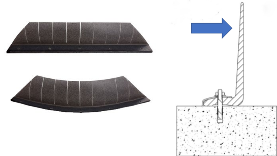
Figur 14 Fleksiterskler er myke og laget av et gummi-Materiale. De skaper vanddyp og hydrauliske forhold som gjør det mulig for fisk å vandre over glatte flater.
