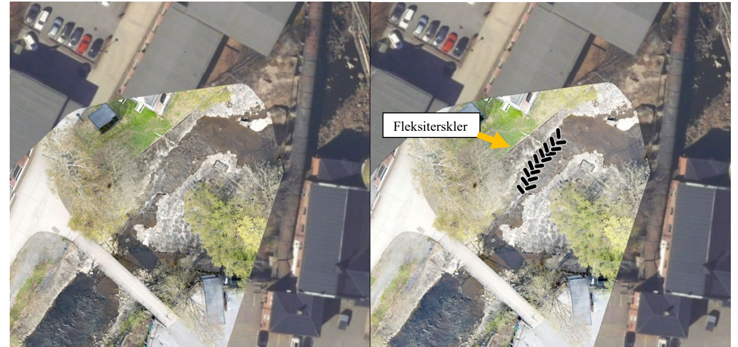
Figur 18 T9 med fleksiterskler i lite fossefall nederst i elva og rett før utløpet fra kraftstasjonen.
