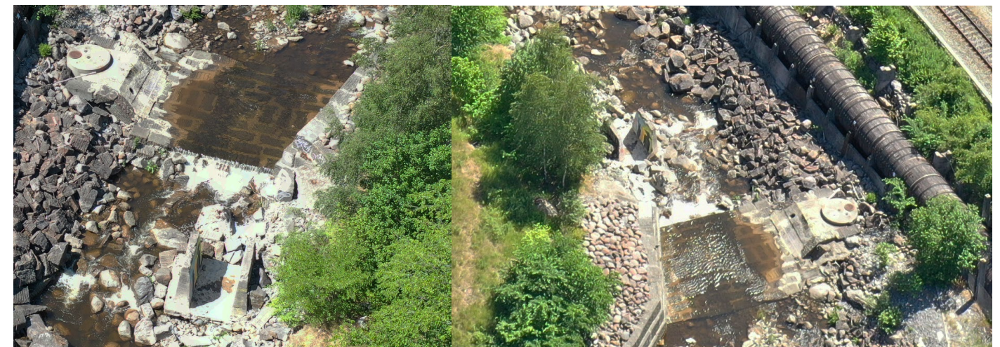
Figur 21 Vannføringen over steinterskelen omtrent midtveis på elvestrekningen den 21. juni med slipp av ca 300 l/s fra Farrisdammen. Til venstre: sett oppstrøms og til høyre sett nedstrøms.
